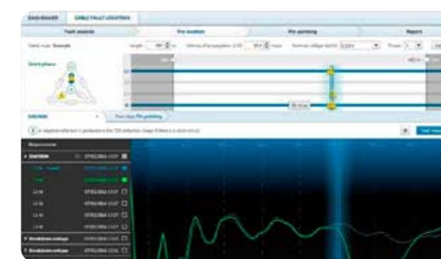
Графический интерфейс программного обеспечения BAUR 4 позволяет наглядно отобразить все важные настройки, параметры определения мест повреждения кабеля и данные кабеля. В нижней части экрана отображаются результаты измерения и предоставлена возможность сразу включить важные данные в протокол.
