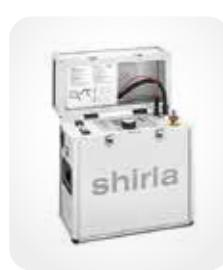
01 / Прибор для испытания кабельной оболочки и локализации повреждений shirla
