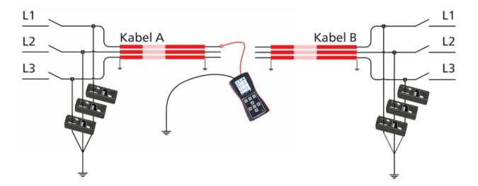
Optional können weitere Sendezangen erworben werden, um die Leiter von bis zu zehn dreiphasigen Kabeln zu identifizieren.
