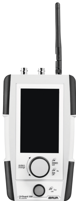
Bild 7: Lokale vollwertige Fernbedienung, hier im Design der Fa. Baur als LVGuard
