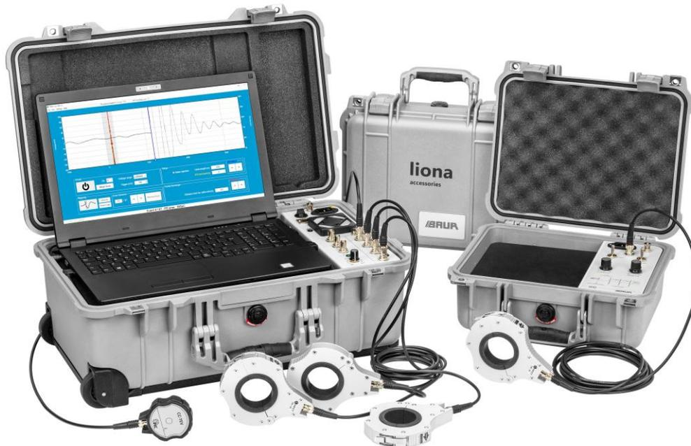
Der Messkoffer mit liona sowie das zur Ortung von Teilentladungen erforderliche Gerät iPD können Teilentladungen ohne Abschaltung der Kabelstrecke erkennen und lokalisieren. (Bild: BAUR GmbH)
