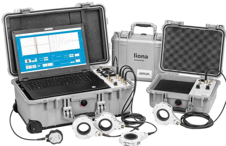
El liona, integrado en una maleta de medición, y el equipo iPD de localización de descargas parciales permiten detectar y localizar este tipo de descargas sin necesidad de desconectar el tendido de cable. (Imagen: BAUR GmbH)
