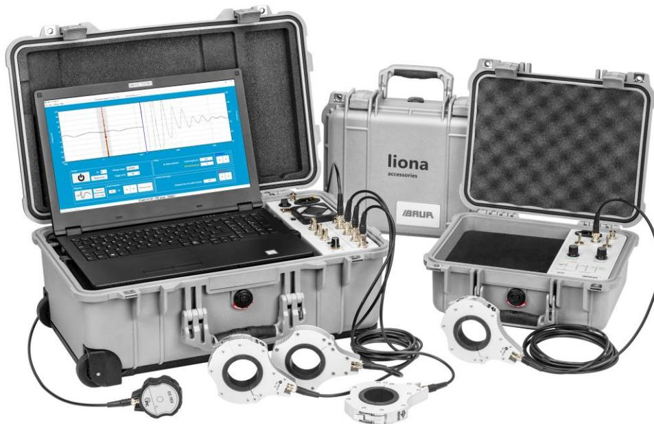
La valigetta di misura con liona e l'apparecchio iPD, necessario per la localizzazione delle scariche parziali, sono in grado di riconoscere e localizzare scariche parziali senza disattivare la tratta di cavo. (Figura: BAUR GmbH)
