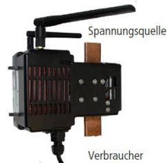
Der intelligente elektronische Leistungsschalter NSG 12000 wird an Stelle der NH-Sicherung direkt in die Sicherungsleiste gesteckt. Er ermöglicht eine Dauerversorgung des Niederspannungsnetzes und übernimmt dabei gleichzeitig die Funktion einer elektronischen Sicherung. Bei einer Auslösung wird automatisch ein Fehlerbild aufgezeichnet: Je nach Ausstattung stehen Ihnen TDR-Reflexionsbilder, Strom- und Spannungsdiagramme sowie Impedanzwerte zur Verfügung.
