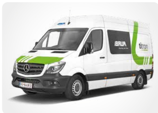
titron® 用于电缆故障定位和诊断的智能测试车
