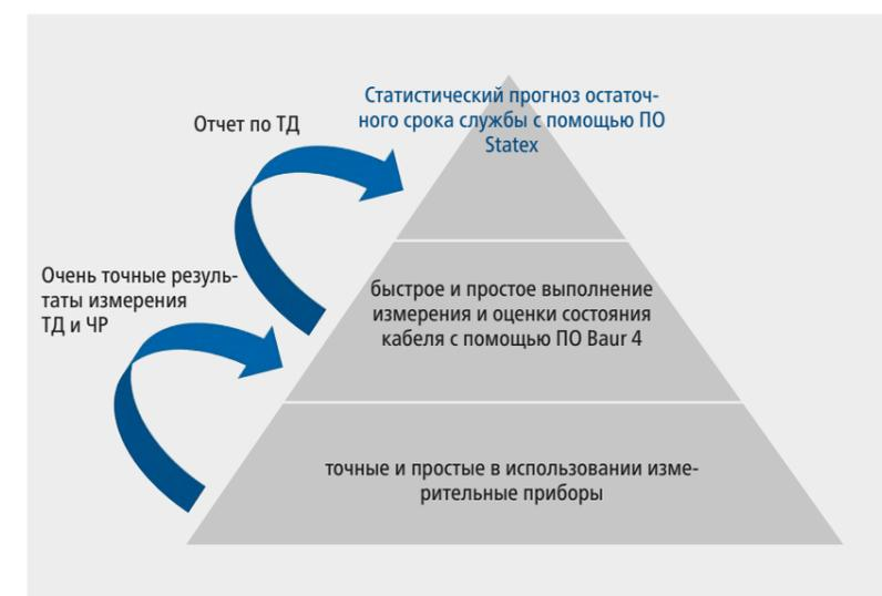
Рис. 3. Новое программное обеспечение Statex предоставляет прогноз оставшегося срока службы кабелей среднего напряжения на основе значений измерения коэффициента диэлектрических потерь.
