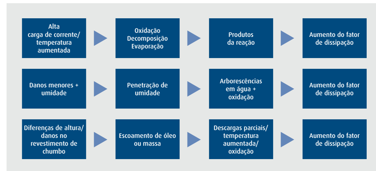
Figura 2. Processos de envelhecimento em cabos de plástico e cabos com isolamento de papel impregnado com base no NEETRAC Diagnostic Testing of Underground Cable Systems 12.2010
