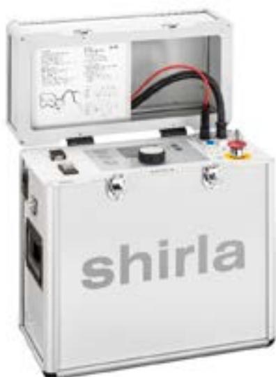
El puente de medición de alta tensión «shirla» permite llevar a cabo la medida según Murray para localizar averías en cables de energía largos y en sus cubiertas.
