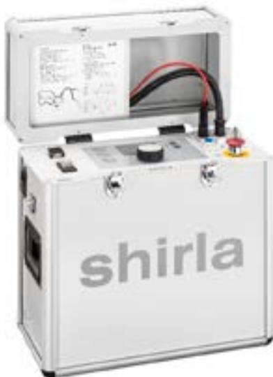
Измерение высоковольтным мостом по Мюррею с помощью прибора shirla для локализации повреждений кабеля и кабельной оболочки протяженных силовых кабелей.
