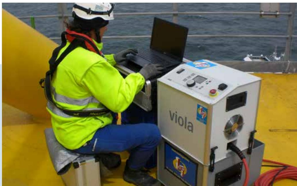
terminé sur cette éolienne et c'est au tour de la suivante. Comme le dit M. Wenzel, les résultats de mesure sont « dans la boîte ». « Le statut de l'essai apparaît immédiatement sur l'appareil de sorte que nous pouvons remarquer directement toute irrégularité. » Outre les résultats de l'essai, le protocole indique également la température extérieure et l'humidité de l'air, le couple de serrage des extrémités et les données de calibrage de la clé dynamométrique et du testeur.
