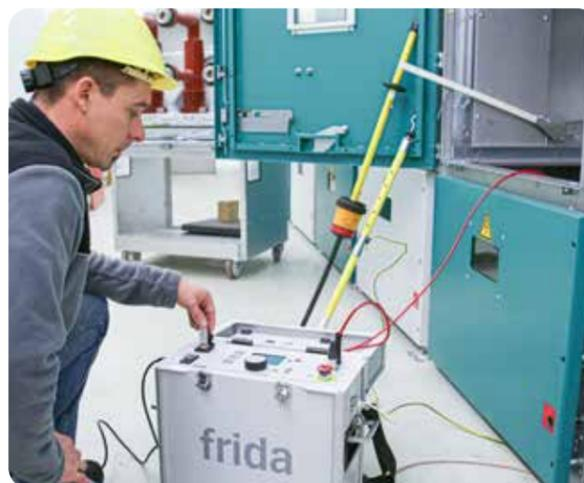
O teste de revestimento e de cabos lhe auxilia na avaliação, se um sistema de cabos está seguro para a operação e pronto para a utilização no instante do teste. Cada vez mais operadores de rede fazem uso do diagnóstico de cabos, uma vez que ele fornece indicações importantes sobre deficiências ocultas nas instalações e, em especial, na rede de cabos.
