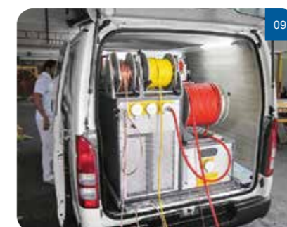
01 / 高压区选项示例: 电动电缆卷筒架、外部紧急关闭装置和 TDR 连接电缆 02 / 带有储藏空间的座椅箱选项示例 03 / 带有合适衬垫的抽屉选项示例 04 / 空调设备示例 05 / 底部同步发电机示例 06 / 电子发电机示例 07 / 信号灯 08 / 警示灯 09 / 使用 BAUR 装备的各种规格的测试车。
