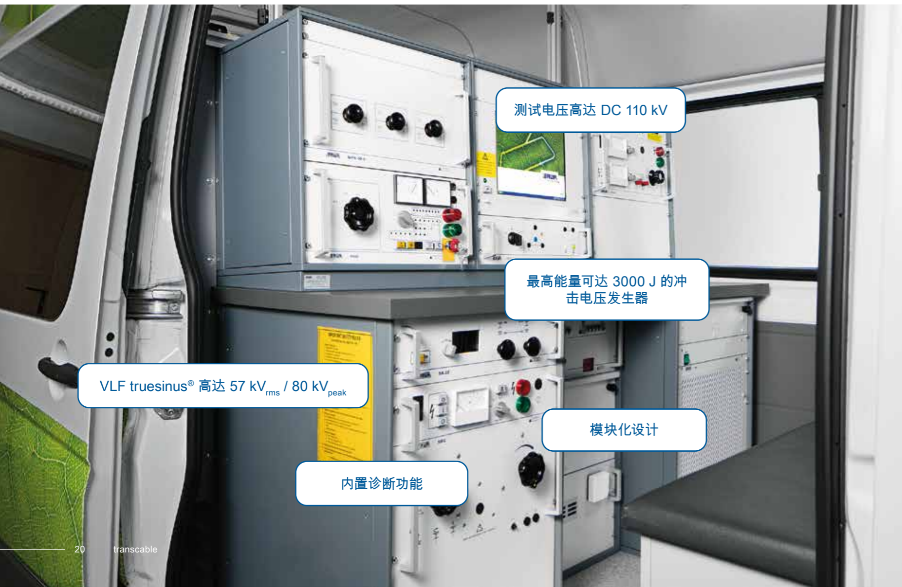
↑ 半自动 transcable 系统, 三相 110 kV
