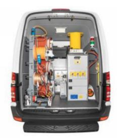
El PD-TaD 80 (a la izquierda con Power Box y ordenador portátil) es un equipo ligero y compacto que se integra perfectamente en vehículos pequeños de medición de cables con un peso máximo de 3,5 toneladas.
