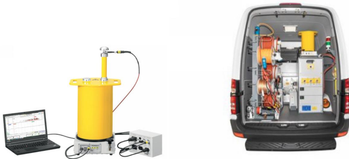
*Il PD-TaD 80 piccolo e leggero (a sinistra con Power Box e PC portatile) si inserisce perfettamente anche in piccoli laboratori mobili con peso massimo di 3,5 tonnellate.*
