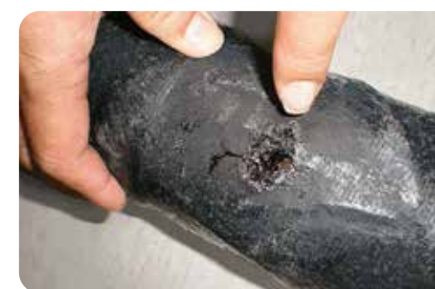
↓ Défaut de câble sur un câble isolé à papier imprégné
