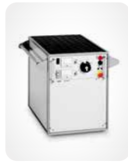
↑ 02 / Trasformatore bruciatore ATG 6000
