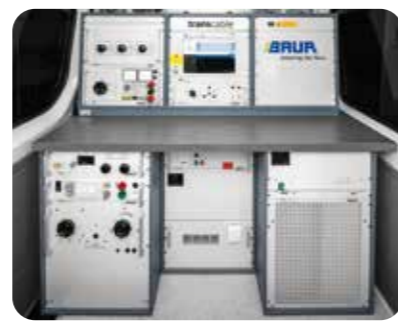
↑ 04 / Laboratorio mobile di ricerca guasti sui cavi transcable
