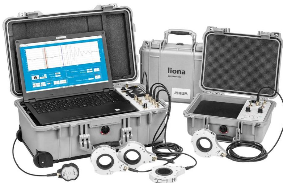
Измерительный кейс с прибором liona и требуемым для локализации ЧР прибором iPD позволяет определять и локализовывать частичные разряды без вывода кабельных участков из эксплуатации. (изображения предоставлены BAUR GmbH)
