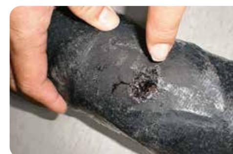
油浸纸绝缘电缆故障
