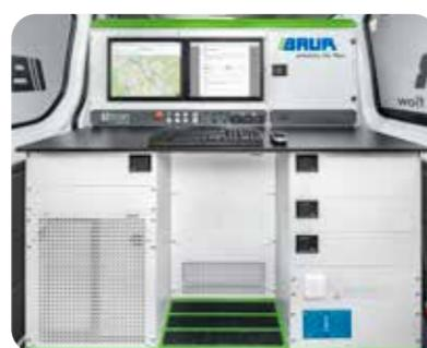
↑ 04 / 电缆测试车 titron®
