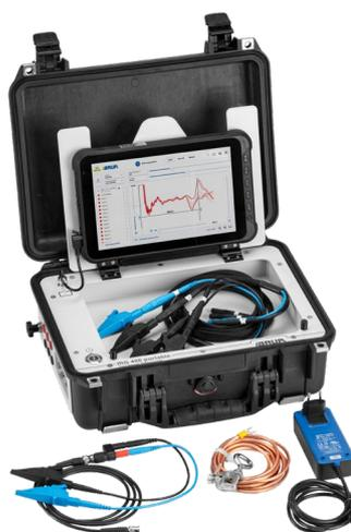
*O reflectômetro de pulso IRG 400 na variante de instalação para um rack de 19" (1 unidade de rack) e na versão de mala portátil com tablet removível. (Figuras: BAUR GmbH)*
