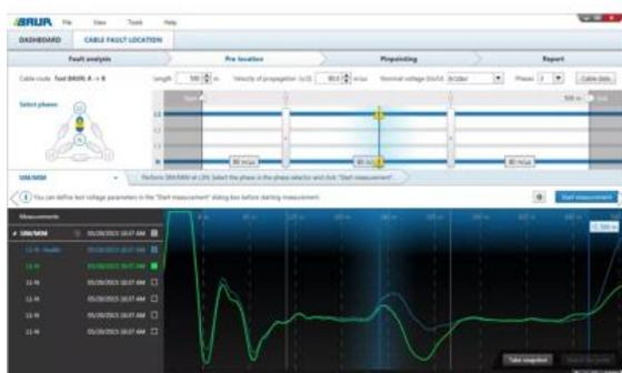
Avec l'aide du Smart Cable Fault Location Guide, la prélocalisation et la localisation précise de défauts de câble sont accélérées. Le logiciel peut également être combiné à la base de données câbles de BAUR et à un système d'informations géographique pour pouvoir limiter encore plus rapidement le type de défaut et l'emplacement du défaut. Même pour la localisation précise de défauts de câble, le logiciel de BAUR est une aide et protège alors même le câble :
