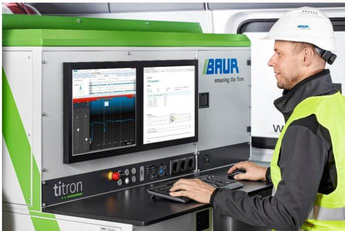
Grâce aux processus mis en parallèle (comme le regroupement de la mesure de Tangente Delta et des décharges partielles en une seule séquence), les tâches de mesure sont réalisées plus rapidement. Les technicien(ne)s saisissent ainsi sur leur temps de travail nettement plus d'informations et génèrent des utilisations supplémentaires pour la gestion des actifs et de l'entretien. Pour exploiter au maximum les
