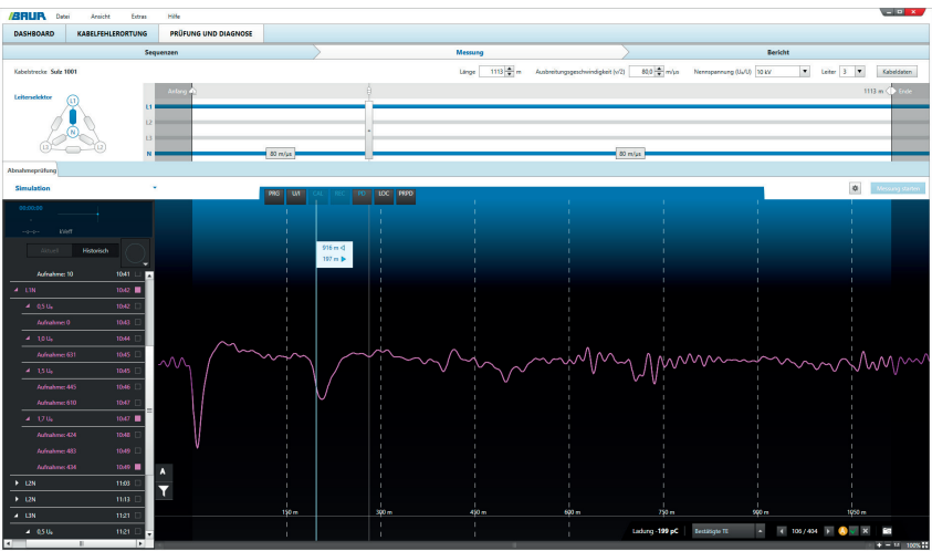
Bild 5. Beispiel für die Darstellung während der Teilentladungsmessung
