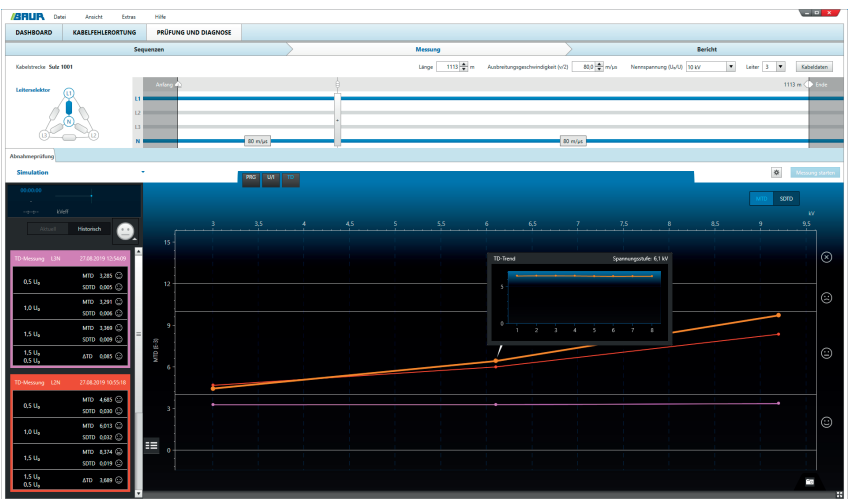
Bild 4. Anhand von Symbolen (linker Bereich) ist der Zustand der Kabel – sogar der einzelnen Phasen – schnell zu erkennen.
