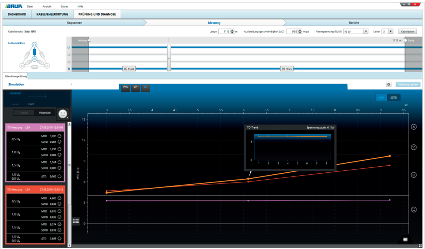
Figura 4. I simboli (area sinistra) consentono di riconoscere rapidamente lo stato dei cavi, perfino delle singole fasi.
