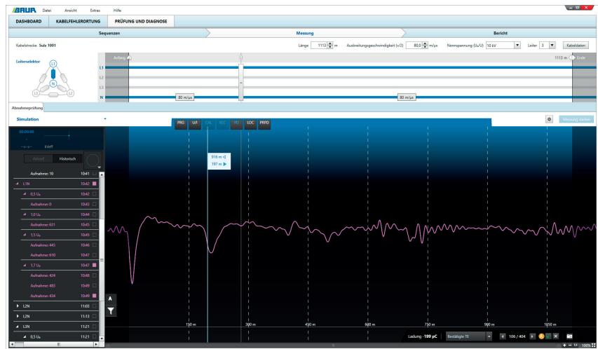
Figura 5. Esempio di rappresentazione durante la misura delle scariche parziali
