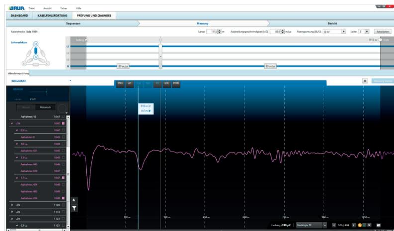
Figura 5. Exemplo de representação durante a medição de descarga parcial
