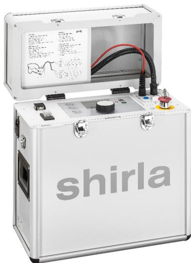
高压测量电桥“shirla”使 Murray 电桥测量能够定位长输电电缆上的电缆故障和电缆护套故障。
