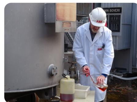
Eric Killer von ABB Sécheron AG (links bei der Probenahme, oben im Labor) ermittelt mit BAUR-Geräten die Durchschlagfestigkeit des Isolieröls sowie Laborwerte, die Rückschlüsse auf den Ölzustand liefern.
