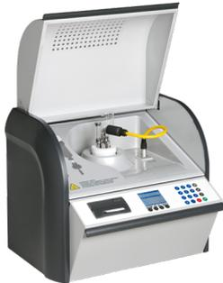
Das Ölprüfgerät BAUR DTL C bietet präzise Informationen für ein effizientes Ölmanagement in Anlagen der Elektrizitätswirtschaft und Industrie. Es misst vollautomatisch den Verlustfaktor, den spezifischen Widerstand und die Dielektrizitätszahl von Isolierölen. Im Gerät sind ab Werk acht verschiedene, den Normen entsprechende Messabläufe hinterlegt (auch nach IEC 61620), um schnell zu umfassenden Analyseergebnissen zu kommen. Zudem lassen sich bis zu zehn individuelle Messabläufe programmieren.
