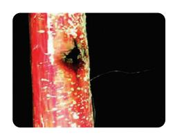
Gracias a la localización exacta con el generador de tensión de choque SSG 1100 integrado en el vehículo de medición de cables y al kit de localización final de BAUR (UL30 y BM 30), unos minutos más tarde se pudo confirmar la evaluación gráfica y el equipo de Advanced Vision pudo encontrar la avería inmediatamente y repararla lo más rápido posible
