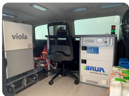
BAUR ha installato tutto il necessario per il collaudo e la diagnosi dei cavi di media tensione in un furgone elettrico per SIG.
