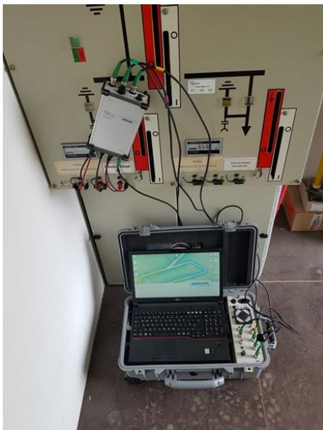
*Raccordement et mesure sous tension : avec le VDS-C, les décharges partielles sont rapidement et facilement détectées sur le câble pendant qu'il est en cours de service. (Illustration : Mitnetz Strom)*
