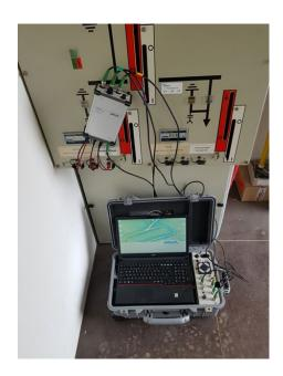
Conectar sob tensão, medir sob tensão: com o VDS-C é possível detectar descargas parciais em cabos de forma rápida e simples durante a operação. (Figura: Mitnetz Strom)
