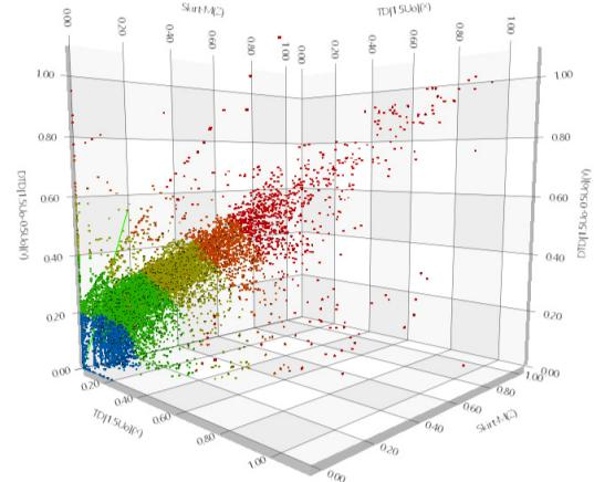
statex® 计算三维老化指数 R，该指数除评估 MTD、 $\Delta$ TD 外，还考虑了新的评估参数 TD-Skirt。这样可以给出准确的建议，何时应进行再次测量或者需要在电缆线路上作业。在对同一根电缆进行重复测量时，statex® 会考虑之前的测量，由此得出更加精确的预测。
