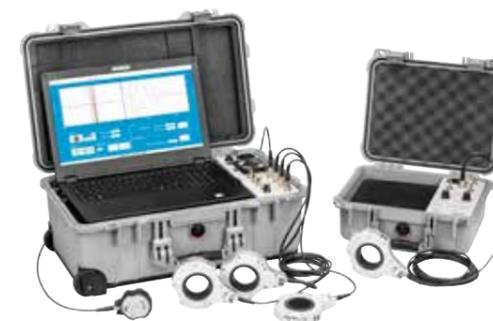
↑ El Iona combinado con el transmisor-receptor iPD localiza descargas parciales de manera precisa y fiable.
