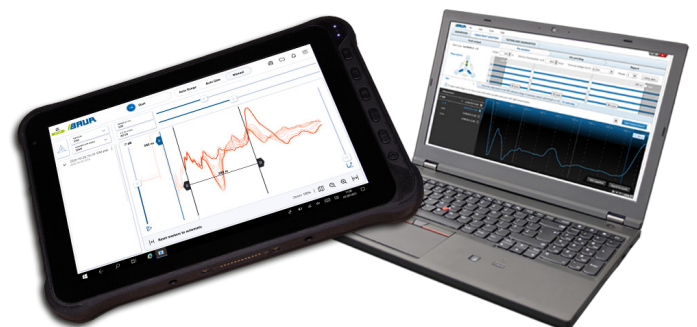
Управление рефлектометром IRG 400 с помощью планшетного ПК или ноутбука (Изображение носит примерный характер)
