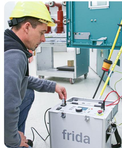
Die Mantel- und Kabelprüfung unterstützt Sie bei der Beurteilung, ob eine Kabelanlage zum Zeitpunkt der Prüfung betriebssicher und einsatzbereit ist. Immer mehr Netzbetreiber setzen jedoch verstärkt auf die Kabeldiagnose, da sie wichtige Hinweise auf versteckte Mängel an den Anlagen und speziell im Kabelnetz liefert.
