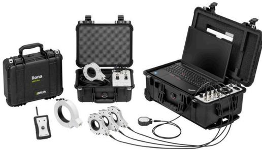
↑ liona in Kombination mit dem iPD-Transponder ortet TE präzise und zuverlässig.
