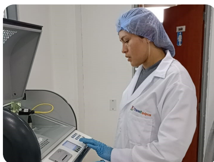
如今，Transequipos 使用 BAUR 的绝缘油介损测试仪 DTL C 工作。
