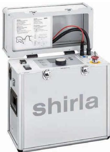
**Hochspannungsmessbrücke »shirla« ermöglicht die Murray-Brückenmessung zur Ortung von Kabel- und Mantelfehlern an langen Energieübertragungskabeln**
