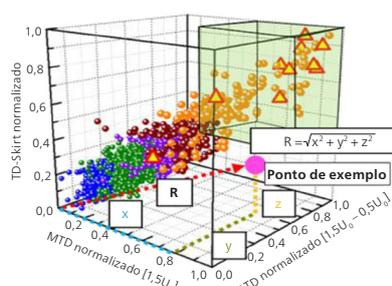
Após uma nova medição, e à nova determinação do índice de envelhecimento R, é calculada a velocidade de envelhecimento e a vida útil restante a ser esperada do cabo, baseado nos índices R das duas medições. Aqui é possível concluir, através da diferença entre o limite de operação econômico e a margem de segurança específica da empresa de abastecimento, quando será necessário atuar no cabo.
