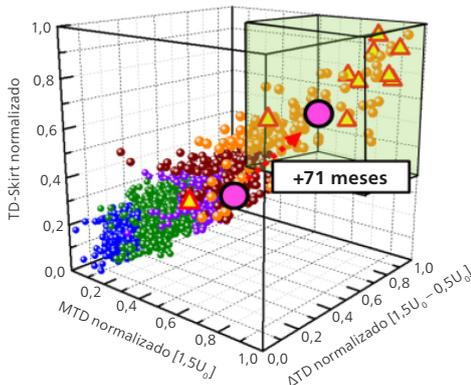
Representação 3D das correlações entre parâmetros de avaliação normalizados de medições de fator de dissipação MTD,  $\Delta$ TD e TD-Skirt: A área emoldurada em cima à direita na figura mostra uma grande probabilidade de falha.
