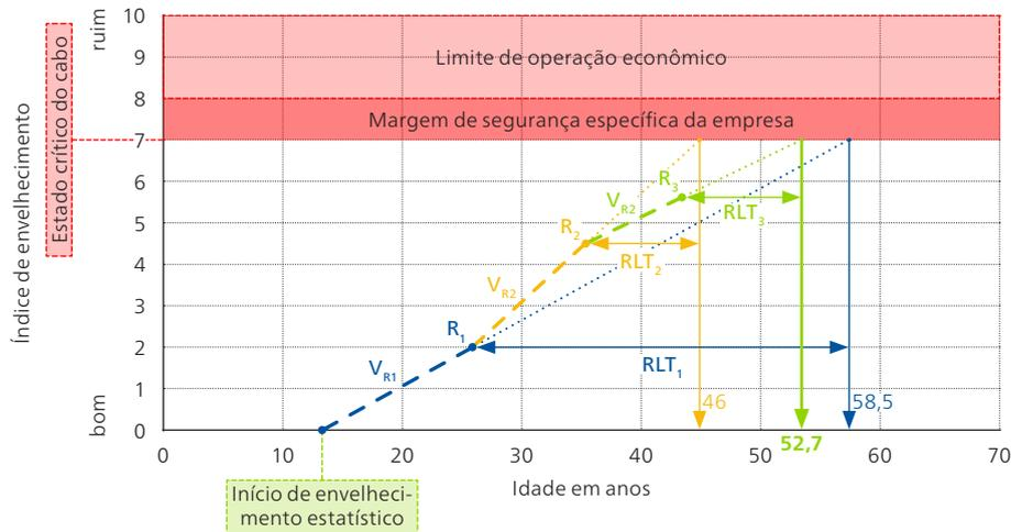
Uma primeira medição de fator de dissipação depois de uma duração de operação DP (duty period) de 26 anos, resulta em um valor para o índice de envelhecimento  $R_1$  do cabo de 2,0. Com isto pode ser calculada a velocidade de envelhecimento  $V_{R1}$  após a primeira medição. Com a velocidade de envelhecimento é possível medir a vida útil restante estatística RLT (remaining life time) do cabo após a primeira medição.
