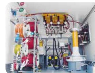
↑ Sistema transcable semiautomático trifásico, 110 kV
