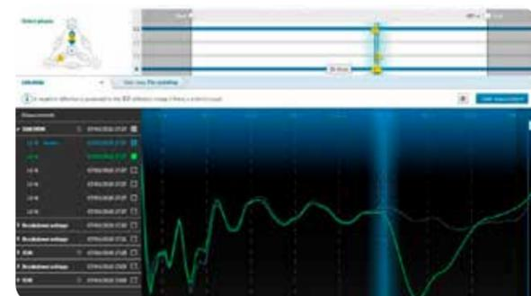
O display do Software 4 da BAUR permite uma visualização abrangente de todos os ajustes importantes, parâmetros de localização de falhas e dos dados do cabo. A parte inferior do monitor exibe os resultados da medição e permite um protocolo imediato de resultados importantes.
