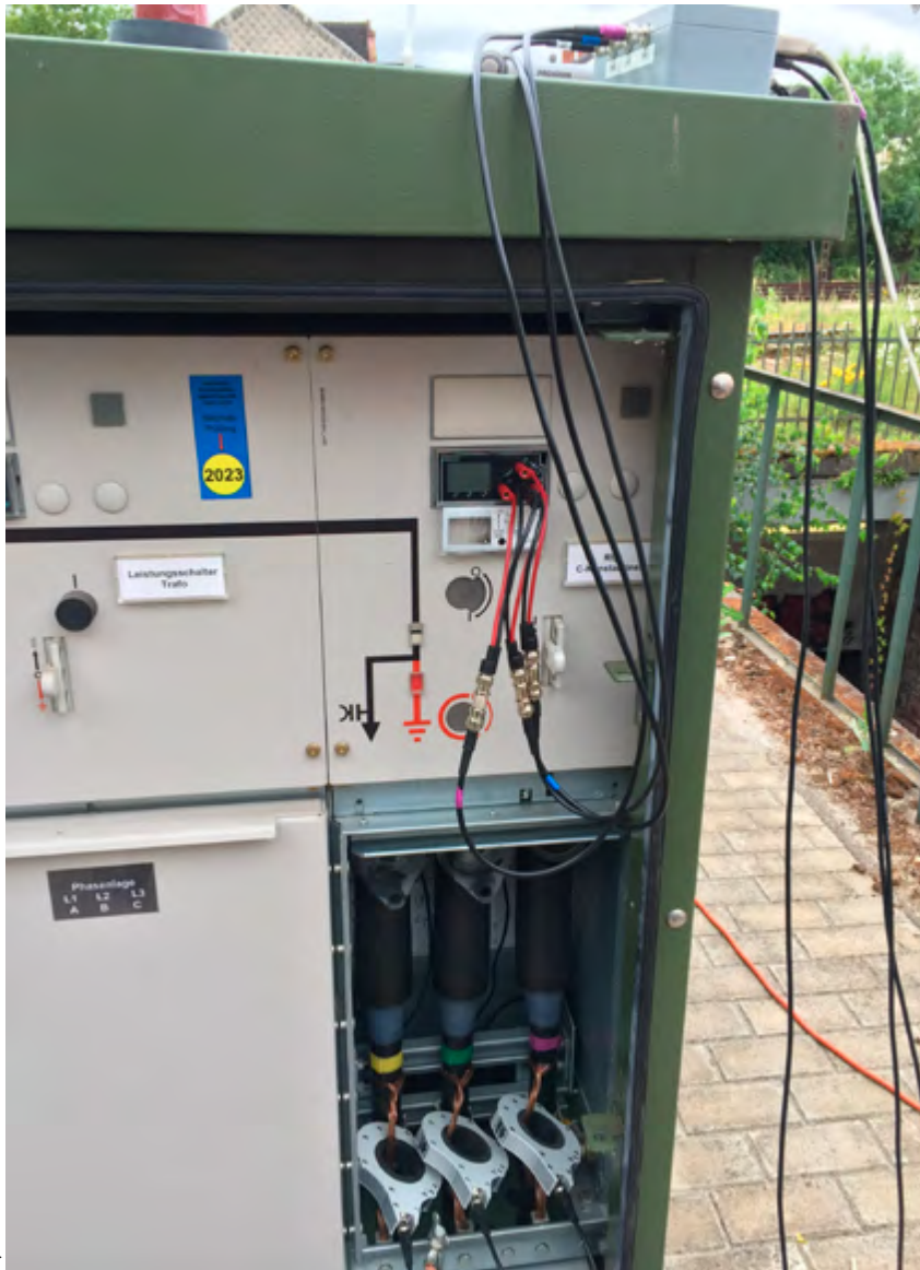
Bild 3. Für den Vergleich der Messqualität wurde das Teilentladungsmessgerät liona sowohl mit dem neuen VDS PD Coupler (oben) als auch mit HFCT-Sensoren (unten) angeschlossen.
