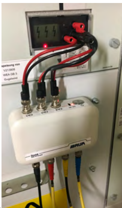
Bild 1. Anschluss des Teilentladungsmessgeräts an den VDS-Buchsen der Schaltanlage eines Windparks
