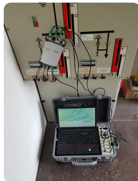
Unter Spannung anschließen, unter Spannung messen: Mit dem VDS-C lassen sich Teilentladungen auf Kabeln schnell und einfach im Betrieb erkennen.
