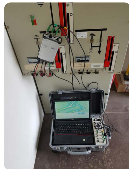
Conectar sob tensão, medir sob tensão: Com o VDS-C é possível detectar descargas parciais em cabos de forma rápida e simples durante a operação.
