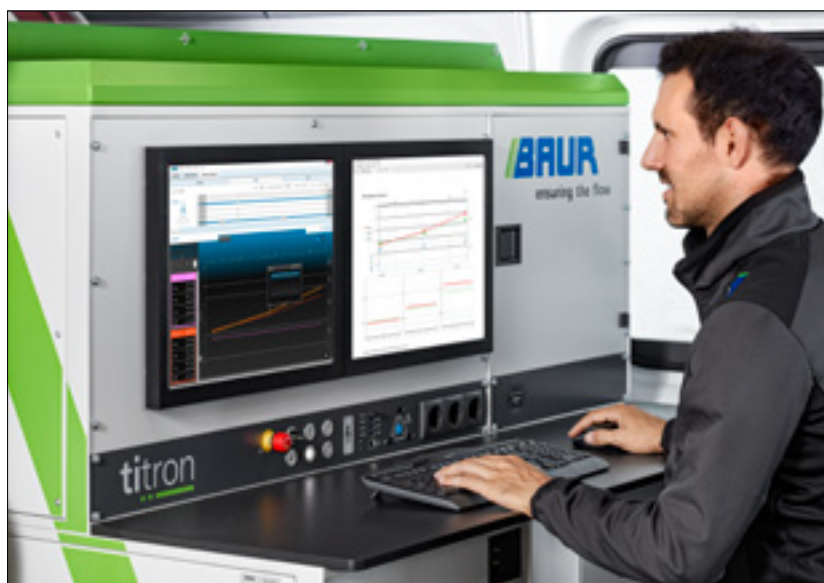
Abbildung 4. In der Baur Software 4 können Messtechniker die Messabläufe durchführen, die Ergebnisse bereits während der Messung betrachten und aussagekräftige Berichte erstellen. Netzbetreiber können auch unternehmensindividuelle Messabläufe und so die geeignete Messmethode für ihre eigene Diagnosephilosophie vorgeben
