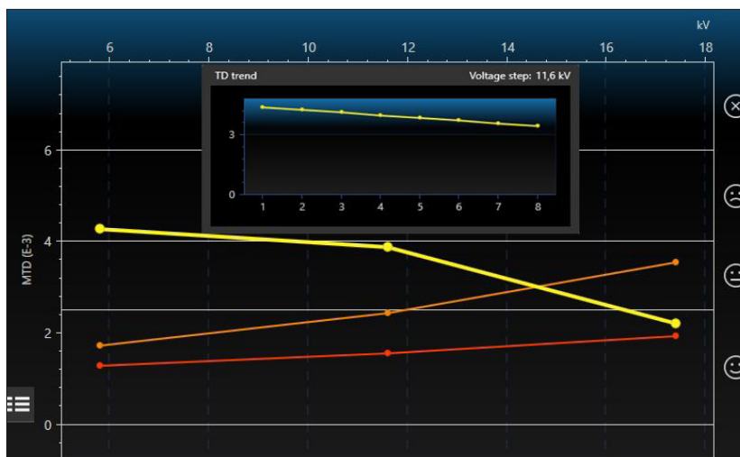
Figura 2. I risultati della misura del fattore di dissipazione possono essere elaborati in loco o in ufficio con il software 4 Baur
