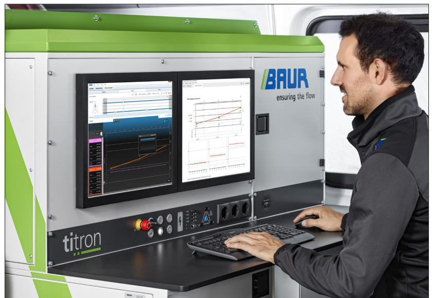
Figura 4. Con il software 4 Baur i tecnici possono eseguire processi di misura, elaborare i risultati già durante la misurazione e creare report con dati affidabili. I gestori di rete possono definire processi di misura personalizzati per l'azienda, selezionando il metodo di misura più idoneo a una specifica filosofia diagnostica
