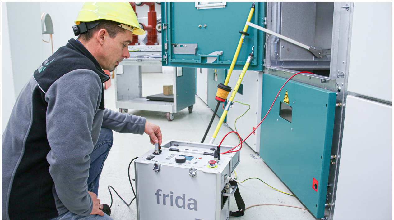
Figura 1. I dispositivi compatti portatili come frida TD consentono di eseguire la diagnostica \tan \delta . I gestori dispongono così di dati importanti per determinare la durata di vita residua dei cavi
