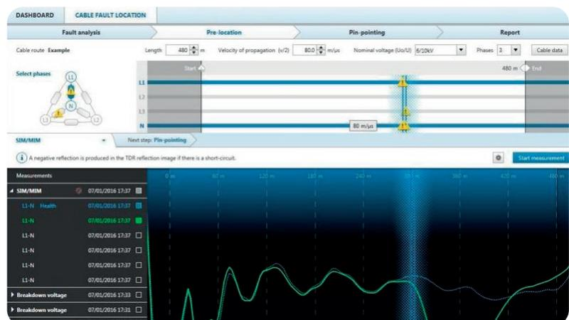
→ Die Anzeige der BAUR Software 4 ermöglicht eine übersichtliche Darstellung aller wichtigen Einstellungen, Fehlerortungsparameter und der Kabeldaten. Der untere Teil des Bildschirms zeigt die Resultate der Messung und erlaubt eine sofortige Protokollierung wichtiger Ergebnisse.
