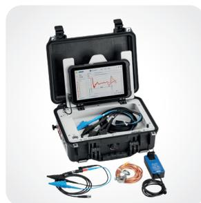
02 / Impulsreflexionsmessgerät IRG 400 portable
