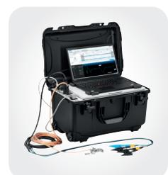
10 / Reflectómetro de impulsos IRG 4000 portable
