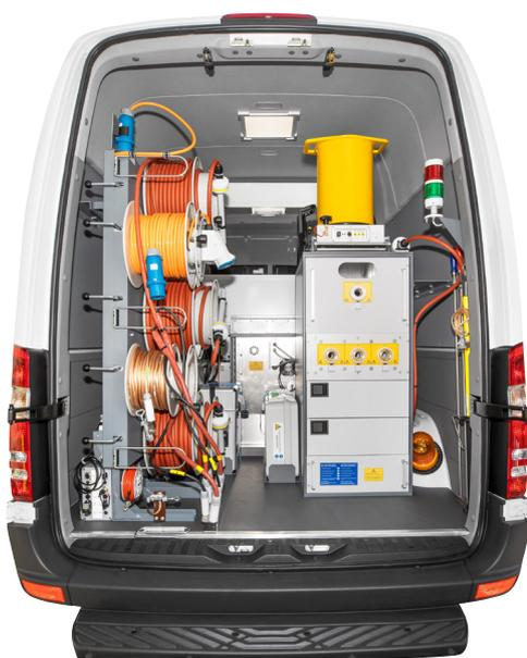
Exemple pour le PD-TaD dans le laboratoire mobile
