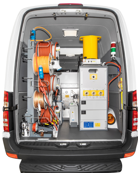
Voorbeeld van de PD-TaD in de kabelmeetwagen
