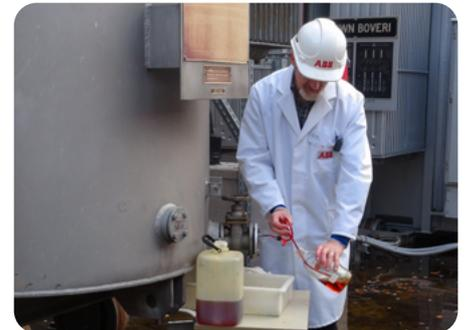
Eric Killer di ABB Sécheron AG misura mediante apparecchi BAUR la rigidità dielettrica dell'olio isolante, così come valori di laboratorio che forniscono informazioni sullo stato dell'olio.
